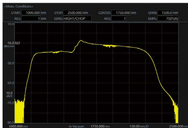
2μm超连续谱光源的测量示例
