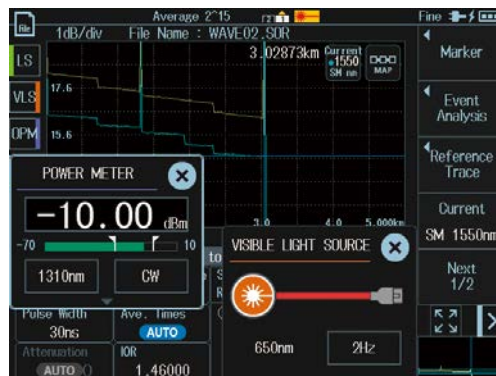
OTDR、光功率计和可见光源的多任务示例
