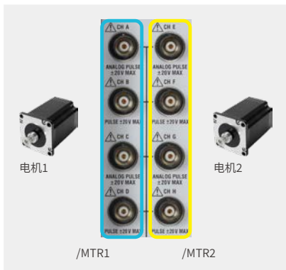
一台独立的WT5000配置用于2台电机的同步测量，以确定A/B和Z相的扭矩、旋转速度、方向和电角度。
